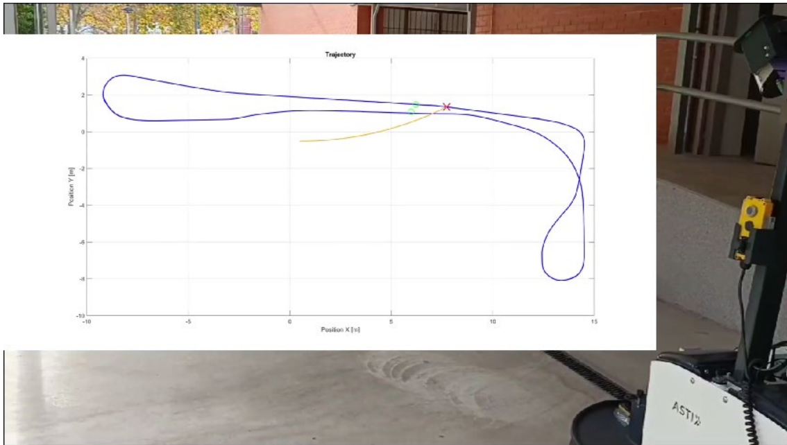
Ilustración 41: Ruta del AMR (azul), posición del AMR (cruz roja), obstáculos detectados (círculos verdes). Se superpone la maniobra de evasión calculada (amarillo)
