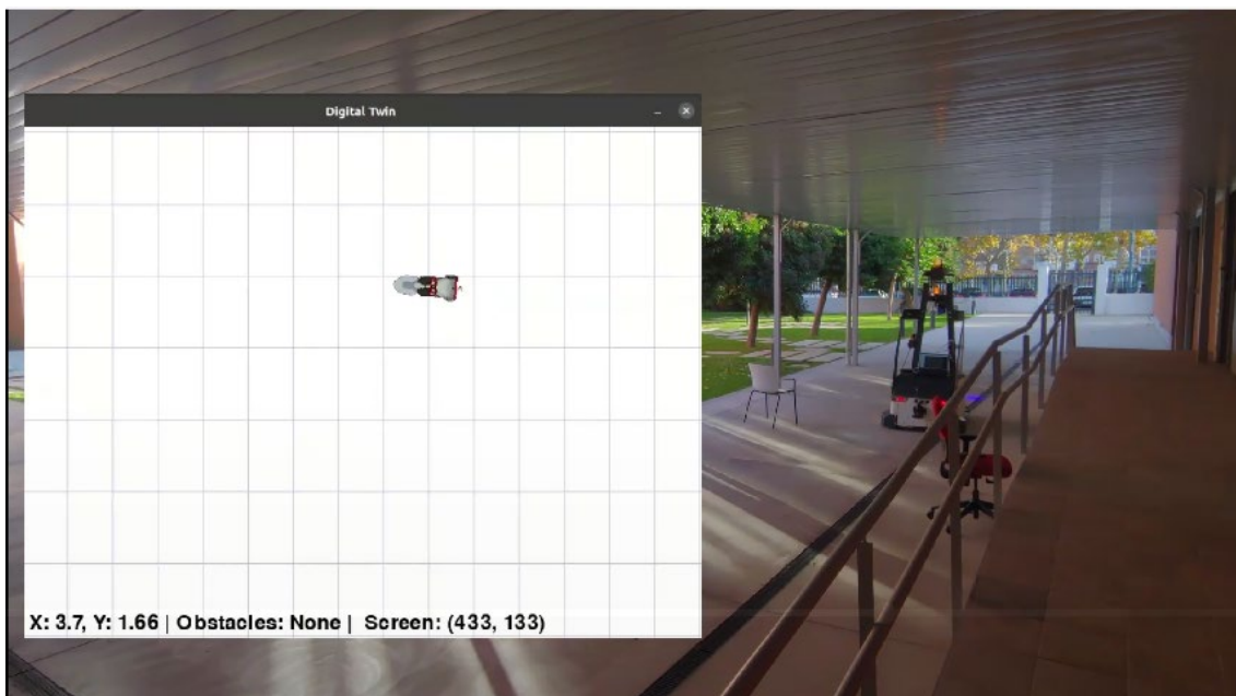
Ilustración 35: Visualización del AGV en el digital twin mientras se encuentra en movimiento
