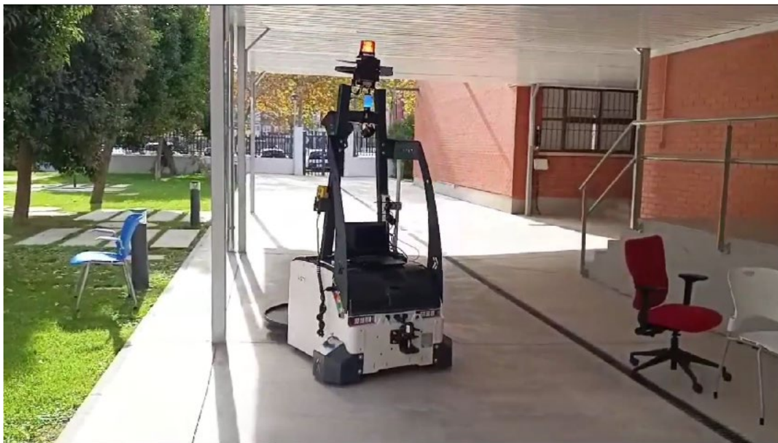
Ilustración 42: AMR realizando la maniobra de evasión
