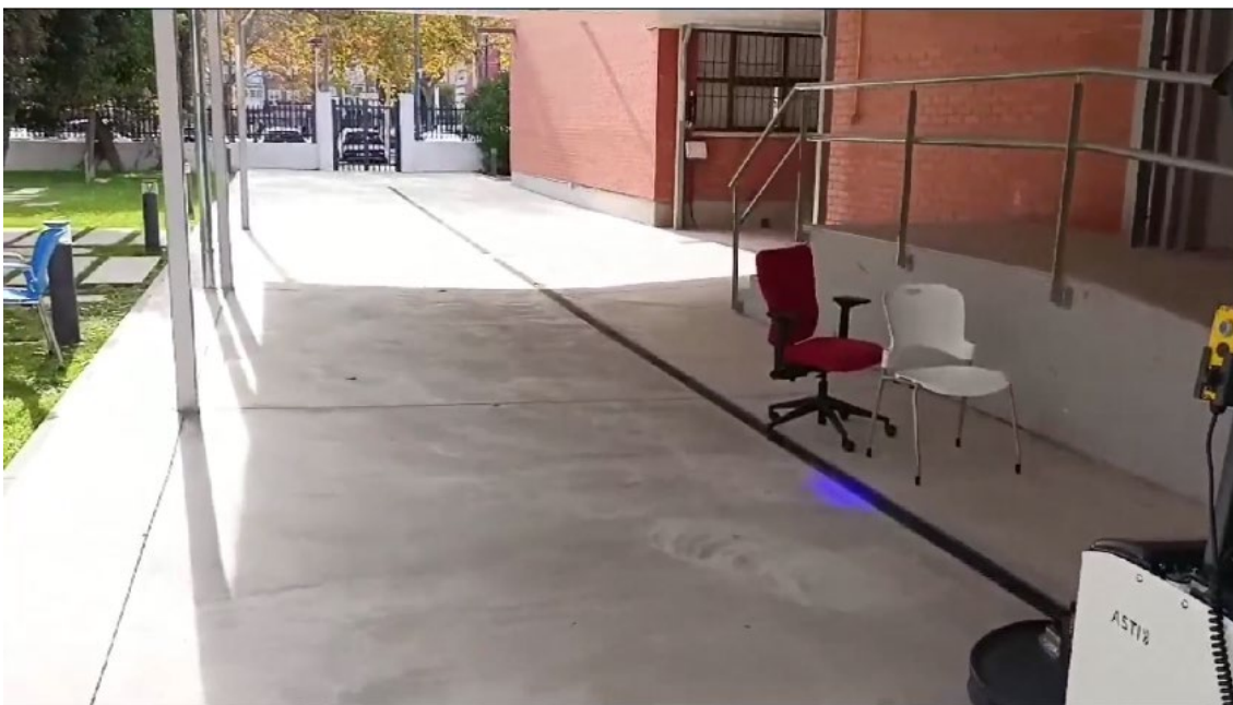
Ilustración 39 AMR en movimiento está cerca de las sillas que obstaculizan el paso, justo antes de realizar la maniobra de evasión
